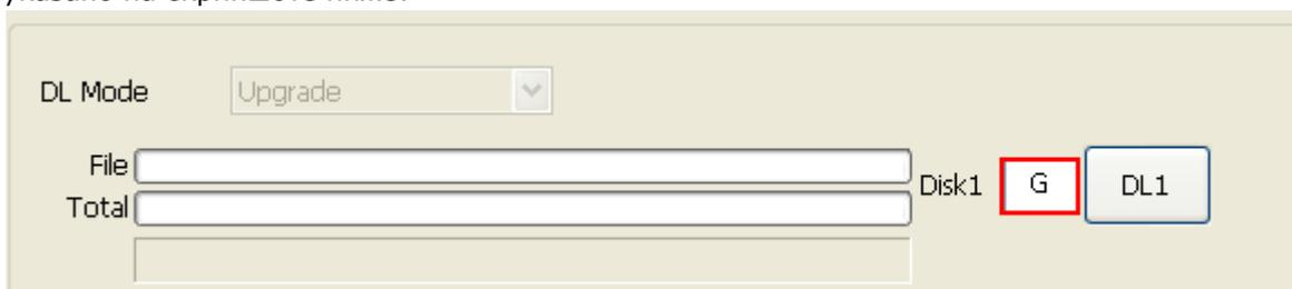
14. Далее нажмите на кнопку «DL1» и начнется процесс перепрошивки. За его ходом можно будет наблюдать по прогресс-бару (**если возникла ошибка после нажатия на кнопку DL1 попробуйте переподключить устройство к другому usb порту**):
